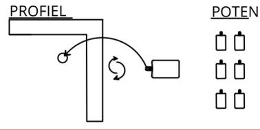
Draai de onderboxen om en plaats deze op een vlakke ondergrond. Bevestig vervolgens de poten uit het montagepakket aan het profiel.
